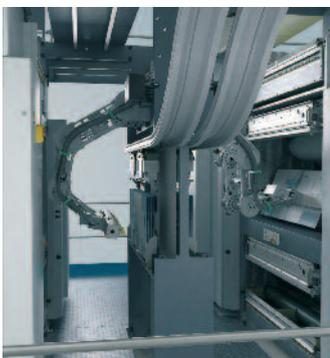
Ein wesentliches Modul der Vollautomatisierung sind die Roboter, die in den Druckwerken die Platten wechseln. Dies geschieht im Druckhaus Barleben in wenig mehr als vier Minuten in allen Druckeinheiten. Selbst den Transport der Platten übernehmen automatisierte Systeme, sodass die Rotation von einer Person bedient werden kann.
